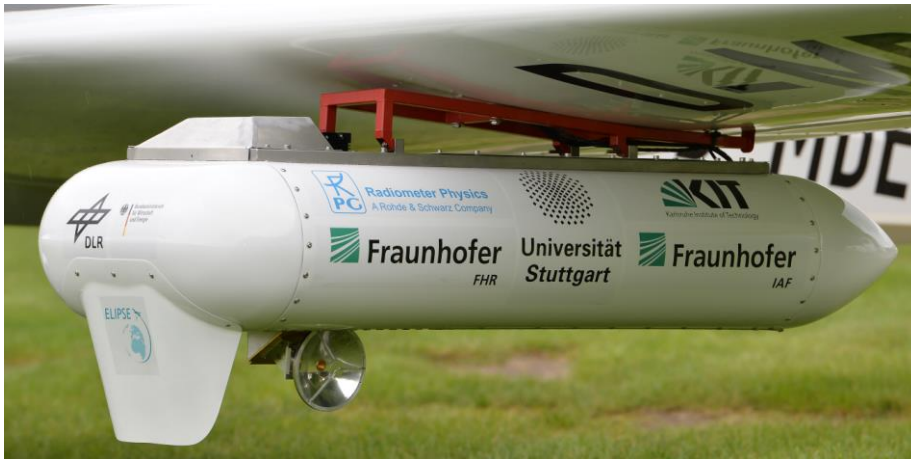
E-Band-Sender am Flügel des Experimentalflugzeugs. Eine kleine Parabolantenne sorgt für die korrekte Ausrichtung auf die Bodenstation. Foto: Fraunhofer FHR/Wolfgang Mies
