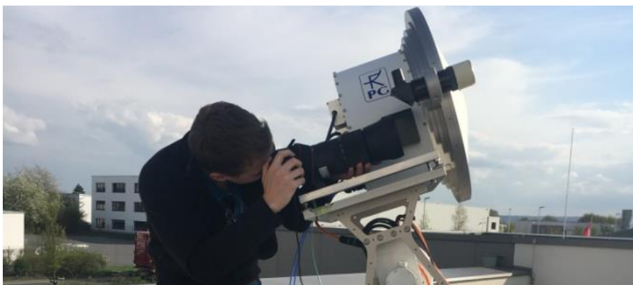
Die Empfangsantenne am Boden ist mit einer Antennennachführung ausgestattet. Foto: Universität Stuttgart/ Parisa Harati,
