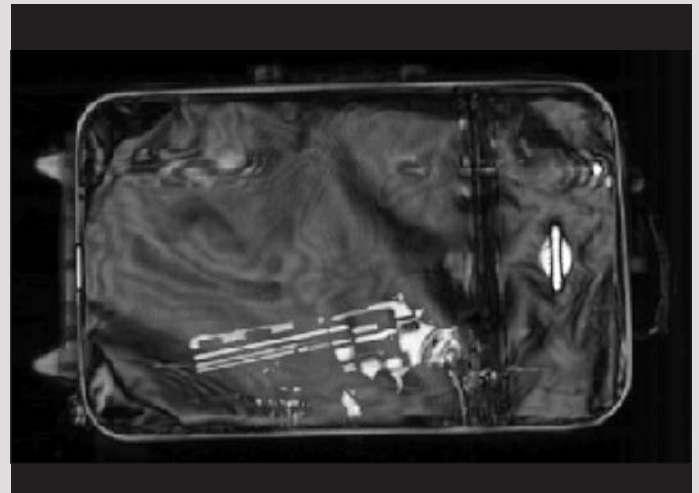
b) rekonstruiertes Bild eines Gepäckstückes, in dem eine Waffenattrappe versteckt wurde
